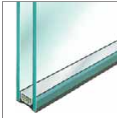
Standardglas Corona S Wärmeschutzglas SchücoTherm Ultra 1.1 Glasaufbau 4-16-4 mm U_g: 1,1 \text{ W/m}^2\text{K} R_w: 32 \text{ dB}
