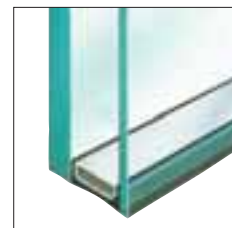
Aufpreis: Schallschutzglas SchücoPhon Ultra 38 Glasaufbau 10-16-4 mm U_g: 1,1 \text{ W/m}^2\text{K} R_w: 38 \text{ dB}
