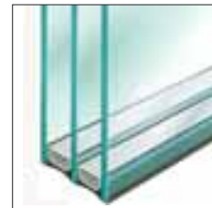
Aufpreis: Wärmeschutzglas, 3-fach SchücoTherm Ultra 0.7 Glasaufbau 4-12-4-12-4 mm U_g: 0,7 \text{ W/m}^2\text{K} R_w: 35 \text{ dB}
